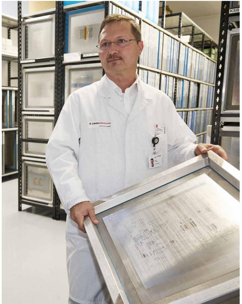
Produktionsleiter Georg Denkinger mit einer Schablone. Sie dient dazu, die Lötpaste gezielt auf die Leiterplatten aufzubringen.
