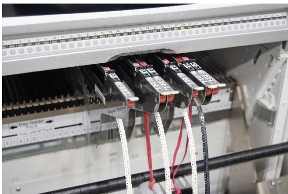
Imagen 2: Los componentes electrónicos se suelen suministrar en rollos. Cada rollo se guía hasta una máquina de montaje que coloca los componentes sobre la placa del circuito.
