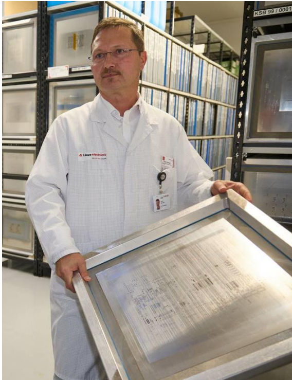
Imagen 1: El director de producción Georg Denkinger con un troquel que se utiliza para aplicar la pasta de soldadura en las placas de circuitos de manera selectiva.
