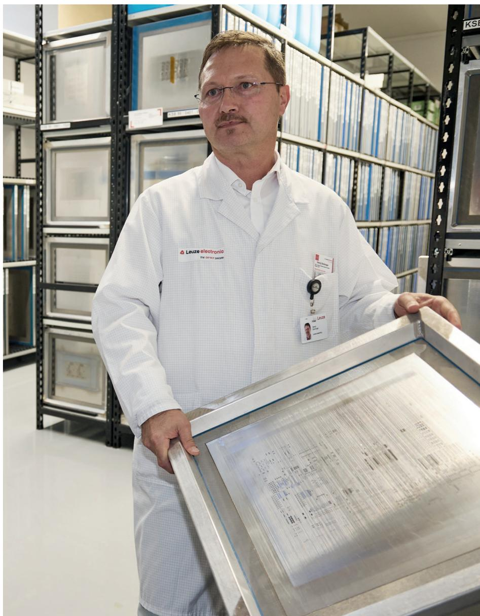
El director de producción Georg Denkinger con un troquel que se utiliza para aplicar la pasta de soldadura en las placas de circuitos de manera selectiva.
